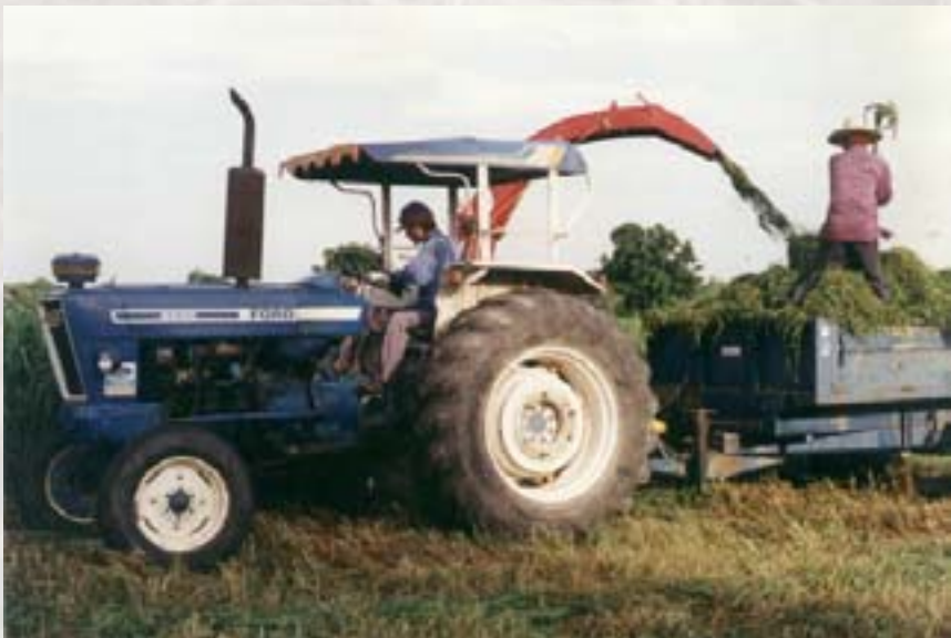
การใช้เครื่องสับหญ้าติดรถแทรกเตอร์
